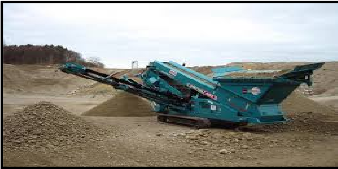
Figura 13. Criba de trituración, como clasificación de los distintos tipos de agregados reciclados. (Fuente: Powerscreen)
