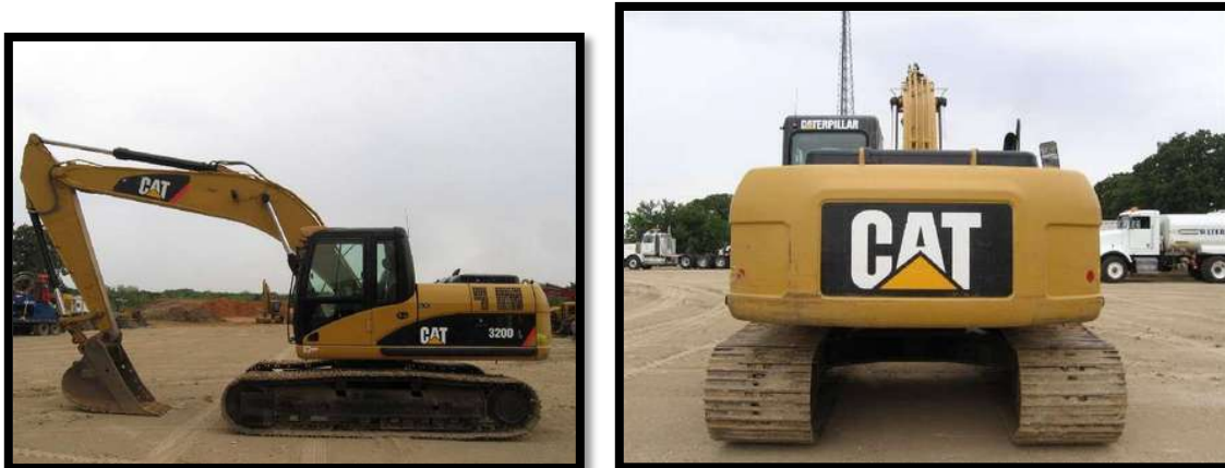
Figura 15. Excavadora hidráulica como alimentación principal a la trituradora primaria. (Fuente: Mercado libre México)
