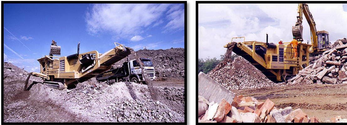
Figura 9. Trituradora de quijadas Extec con capacidad de 480 ton/día. (Fuente: catálogo de equipos Extec)
