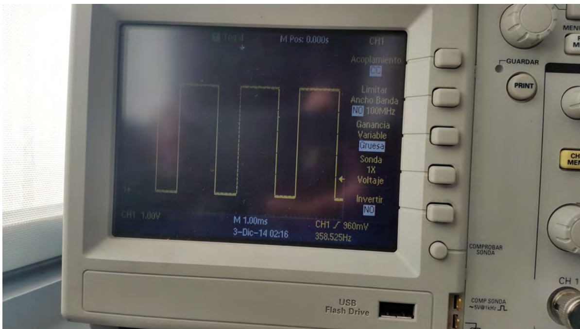
Figura 4.5: Señal adecuada para ser decodificada por el FF-D.
