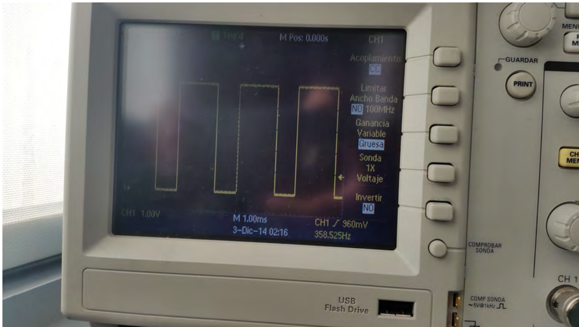
Figura 3.41: Adecuación de la señal mediante la compuerta NOT con ST.
