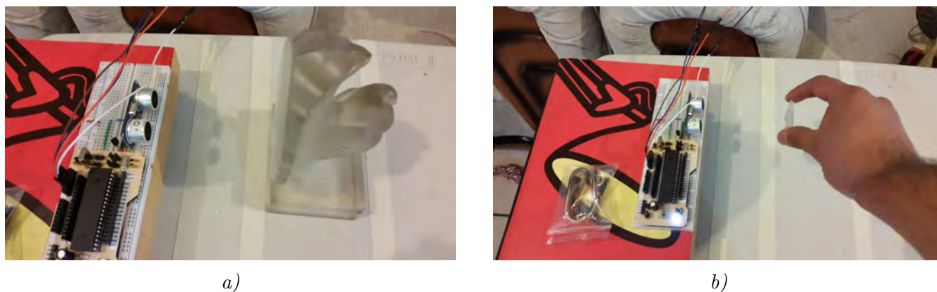
Figura 4.11: Elementos de prueba para conocer el comportamiento del sensor. Un separador de libros, a), que tiene un área bastante grande para ser detectado y un cartucho de videojuegos, b), muy pequeño en comparación.
