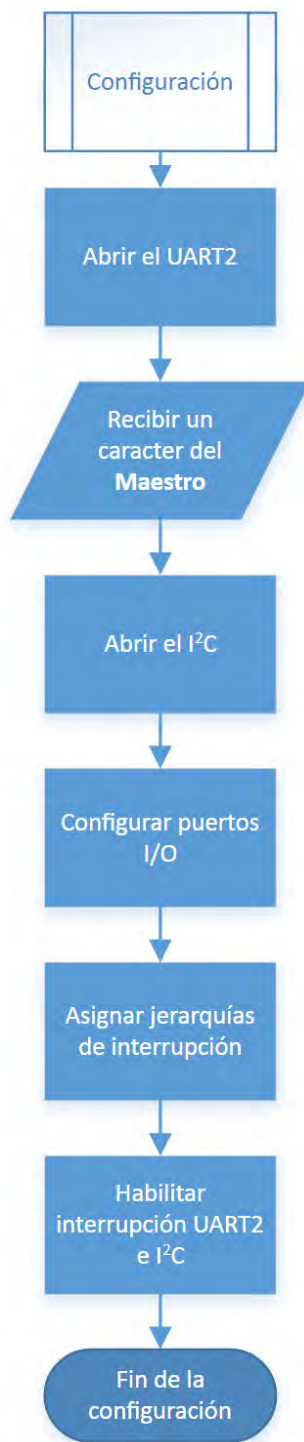
Figura 3.89: Diagrama de flujo de la configuración inicial del Esclavo .
