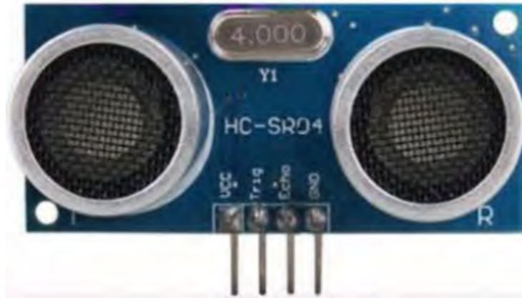
Figura 3.53: Sensor ultrasónico HC-SR04 [8].
