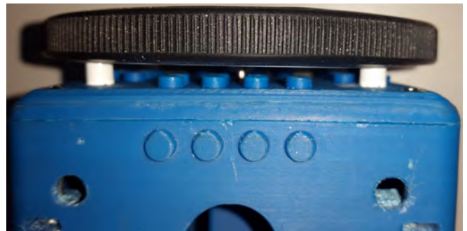
Figura 4.30: Los LEDs fueron recortados lo suficiente para no interferir con la estructura de la llanta.
