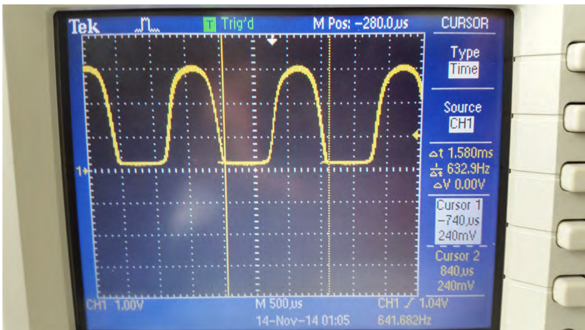
Figura 4.2: Se aprecia una señal del motor alimentado a 6 [V]. La señal no es cuadrada pero se puede diferenciar bien el estado alto y el bajo.
