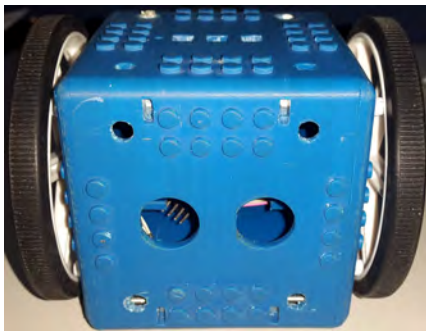
Figura 4.30: Los LEDs fueron recortados lo suficiente para no interferir con la estructura de la llanta.
