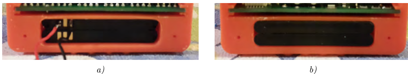
Figura 3.16: En a) se aprecian las baterías montadas desde un costado y en b) se aprecia el otro costado, de tal forma que se puede acceder a las baterías por ambos costados laterales del cubo.
