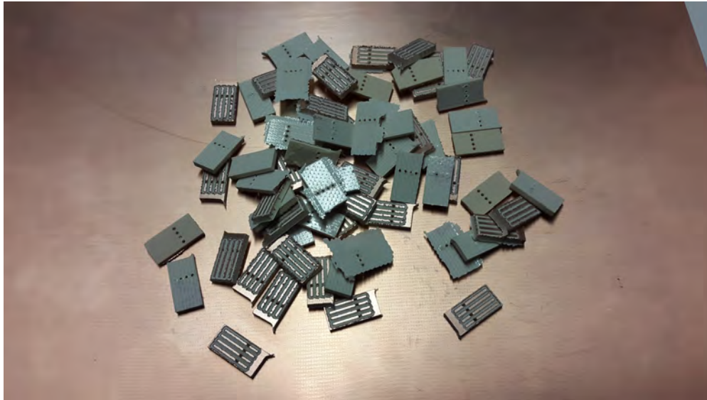
Figura 3.59: PCBs para los LEDs RGB.
