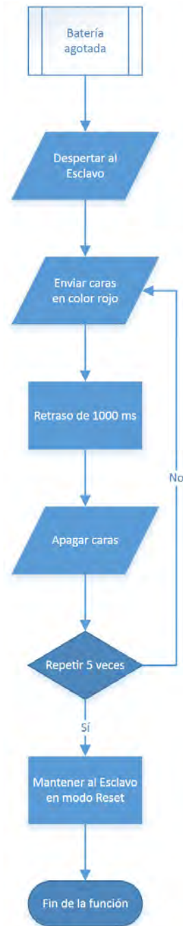
Figura 3.87: Diagrama de flujo de la función de parpadeo para indicar que la batería se ha agotado.
