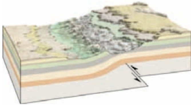
Figura 3. Esquema de un monoclinal donde se observa la falla inversa en el basamento, flexionando las rocas que lo sobreyacen. Modificado de Tarbuck, 2005.
