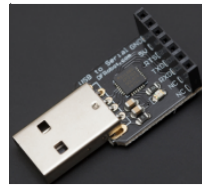
(a) Convertidor genérico TTL/USB para los módulos de bajo costo, requiere de la búsqueda y prueba de los respectivos drivers, lo que puede llevar al fallo de comunicación entre ambos.
