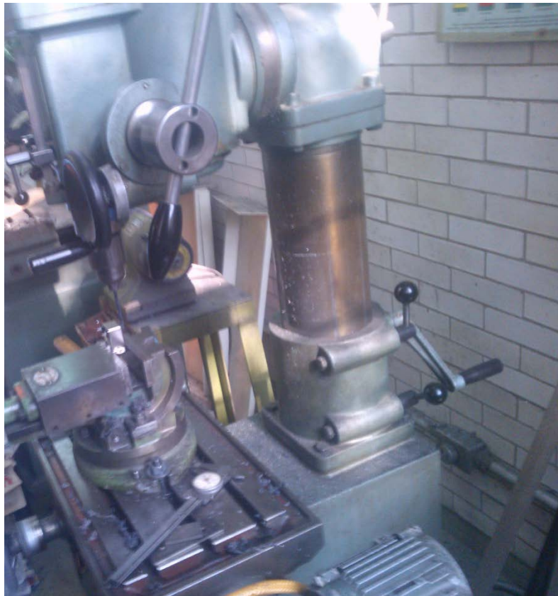
Figura 47. Taladro fresador y prensa que se usará en el proceso de fabricación de las piezas
