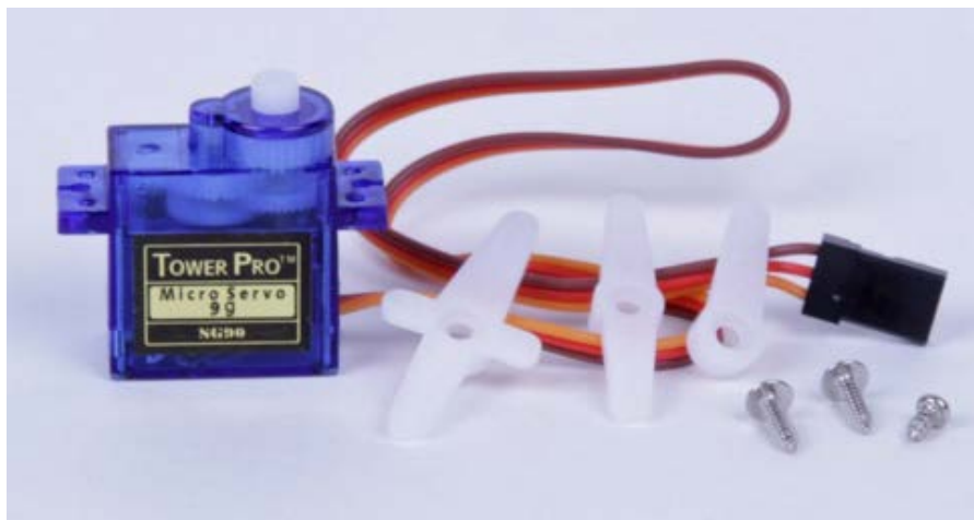
Figura 37. Micro servomotores para el desplazamiento del brazo
