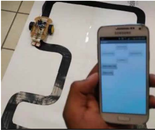
(a) Operación remota con bluetooth y aplicación en dispositivo móvil de un robot.
