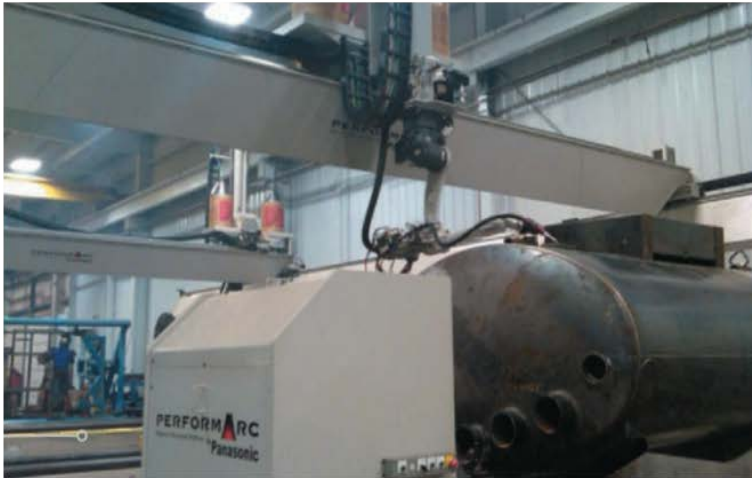
(a) Robot cartesiano, utilizado en la soldadura de tanques
