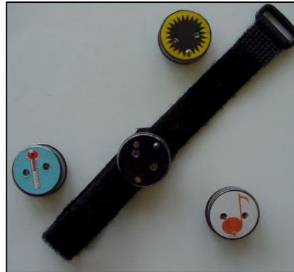
FIGURA 1.6. Actígrafo de la marca Micro-Mini Motionlogger con accesorios para monitorizar cantidad de luz, sonido y temperatura.
