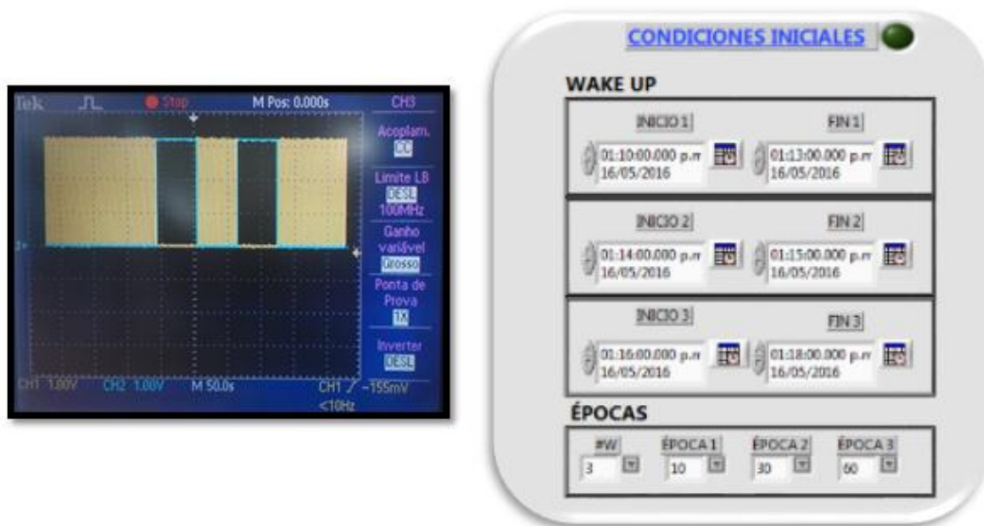
FIGURA 4.4. Señales vista en el osciloscopio y las condiciones iniciales programadas, primera prueba.
