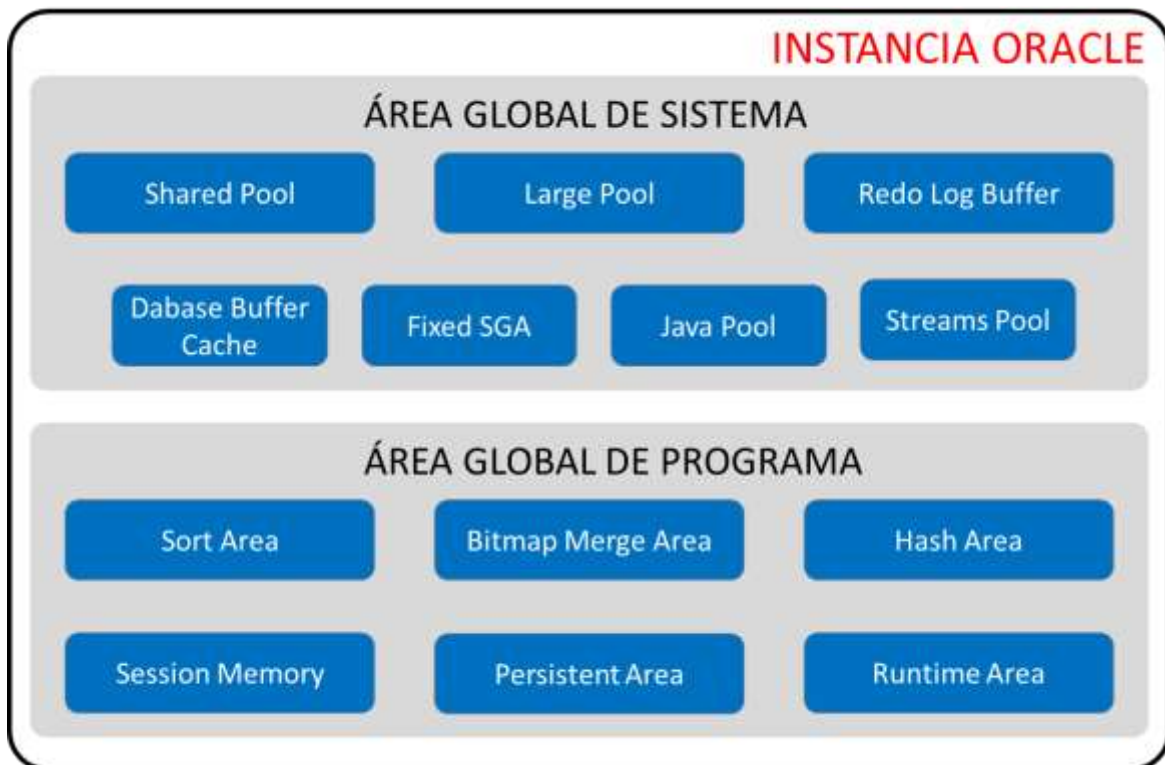
Img 17. Ejemplo de instancia RDBMS
