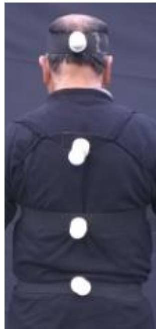
Figura 4. 6 Distribución de acelerómetros en plano frontal vista anterior del trabajador agrícola.
