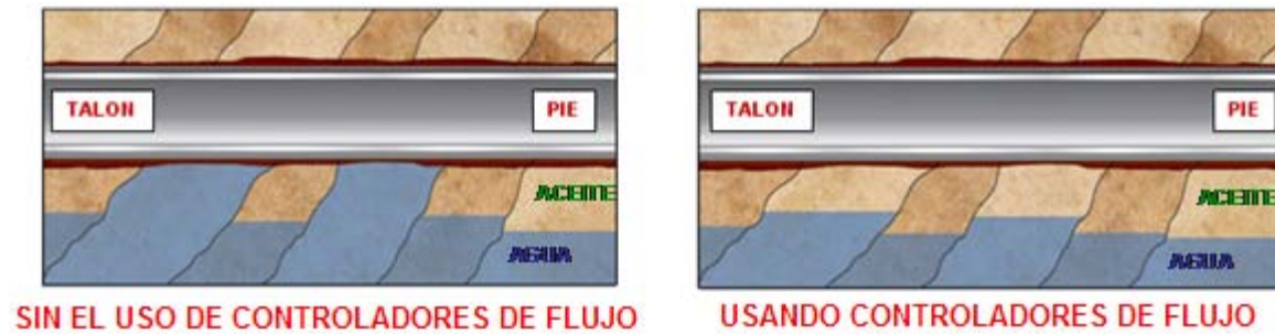
Figura 3. Perfil de caída de presión y entrada de agua en yacimientos heterogéneos.
