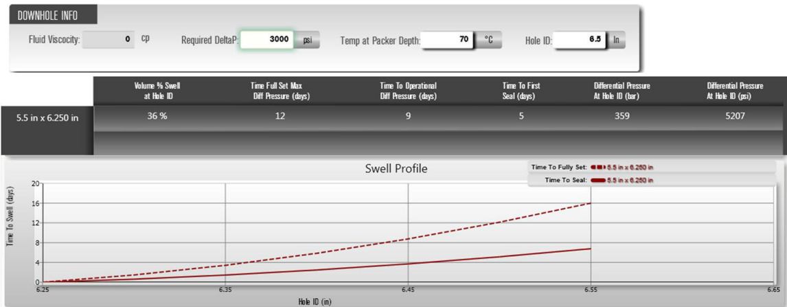
Gráfica 3. Resultados obtenidos de simulador Easywell, donde se varió la temperatura a 70 °C, obteniendo un resultado de 12 días para resistir la máxima presión de operación.
