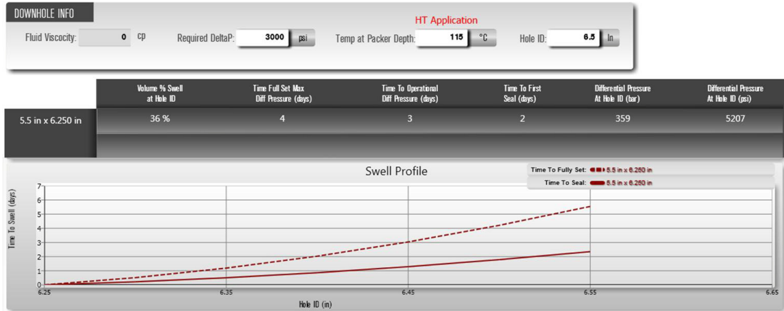
Gráfica 4. Resultados obtenidos de simulador Easywell, donde se varió la temperatura a 115 °C, obteniendo un resultado de 4 días para resistir la máxima presión de operación.
