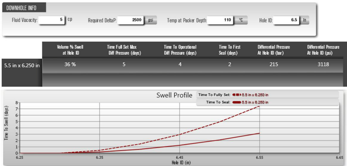
Gráfica 1. Resultados obtenidos de simulador Easywell, donde se varió la viscosidad a 5 cP, obteniendo un resultado de 5 días para resistir la máxima presión de operación.
