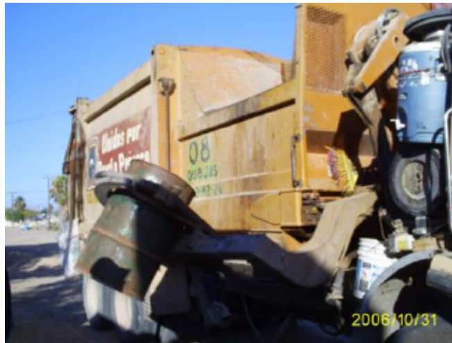
Figura 5.5 Camión recolector con levantacontenedor de carga lateral
