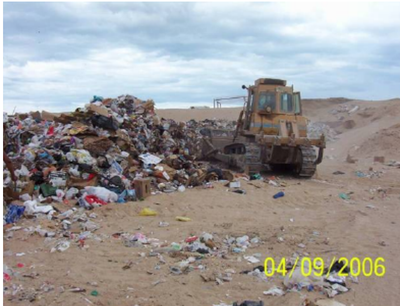
Figura 5.9 Tractor D-7 acomodando los residuos sólidos
