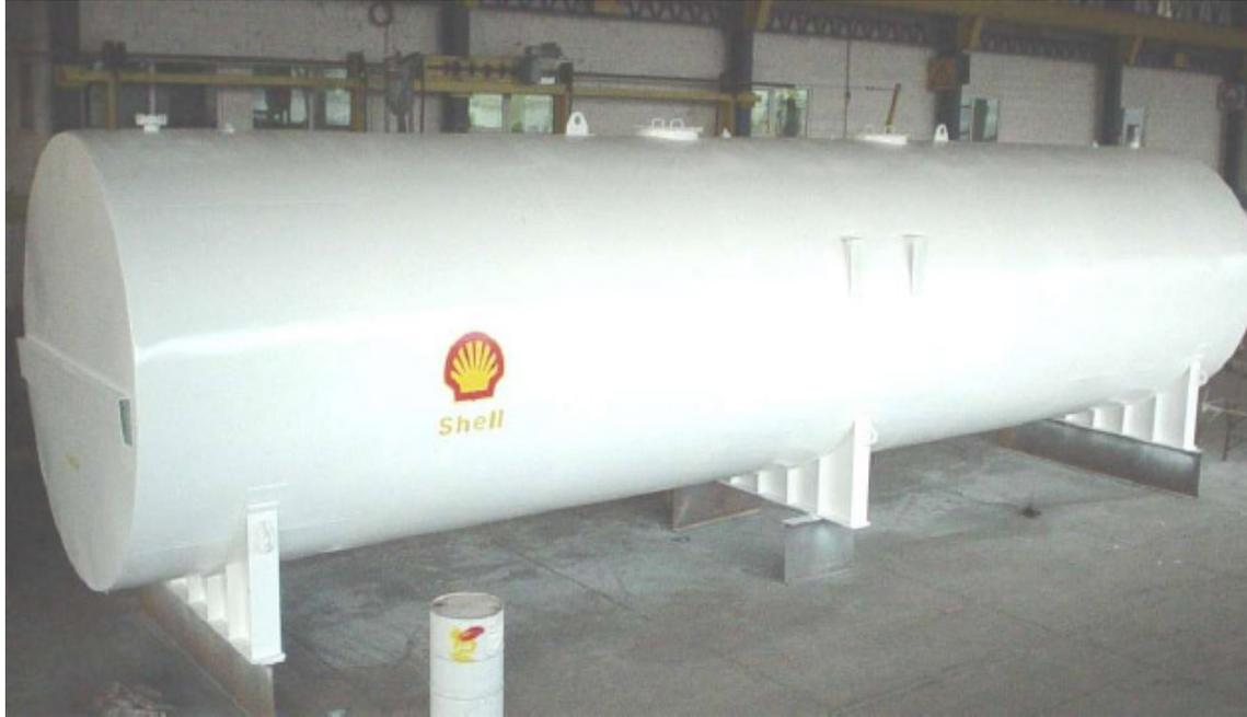
Figura 2. Tanque horizontal para almacenamiento de gas.
