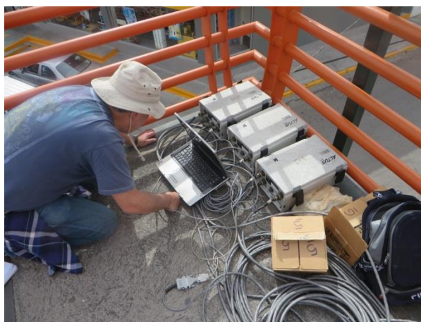
Figura 4.6 Instrumentación del puente peatonal Salamanca mediante acelerómetros FBA ES-T, Kinometrics
