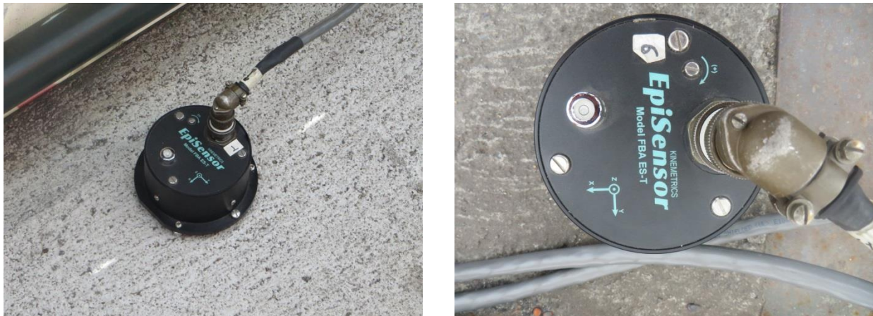
Figura 4.1 Acelerómetro modelo FBA ES-T, Kinometrics
