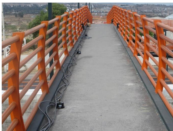
Figura 4.6 Instrumentación del puente peatonal Salamanca mediante acelerómetros FBA ES-T, Kinometrics
