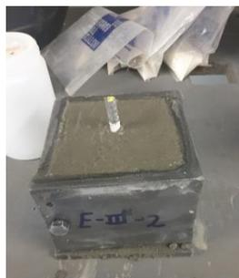
*Figura 13. Probeta lista para curado*
