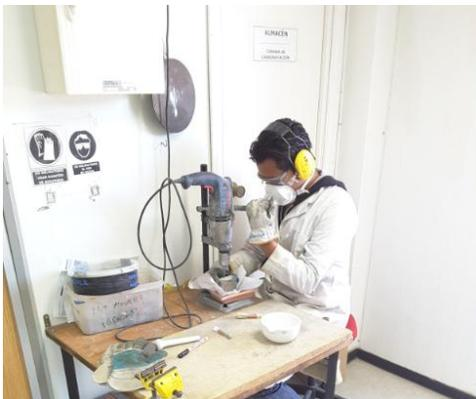
Figura 34. Obtención de muestras de cloruros
