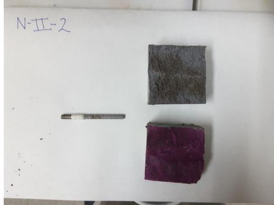
Figura 48 Aplicación de fenolftaleína para prueba de carbonatación
