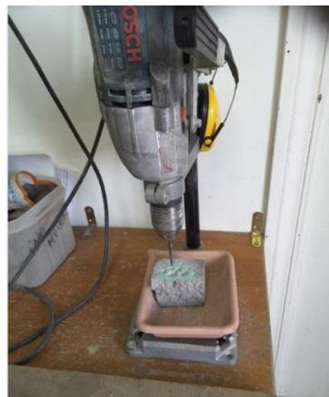
Figura 35. Obtención de cloruros en la superficie de la probeta
