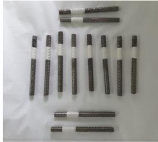
Figura 6 Acero limpio y delimitado listo para ensaye
