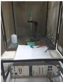
*Figura 25 Electrodo de referencia*
