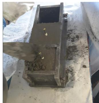
*Figura 12 Vertido de mezcla en moldes*
