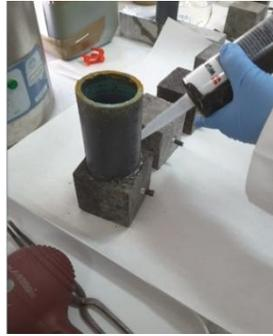
*Figura 17. Cordón de silicón entre probeta y molde*
