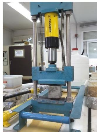
Figura 31. Probeta preparada para ser partida
