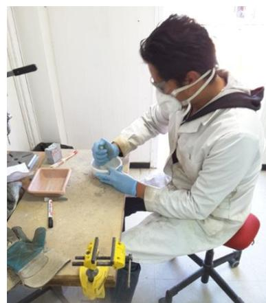
Figura 37. Trituración de muestra de cloruros
