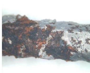
*Figura 42. Acero de la probeta E-III-1*
