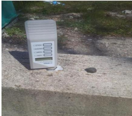
Figura 50 Se toma la temperatura ambiente y del elemento con un termómetro
