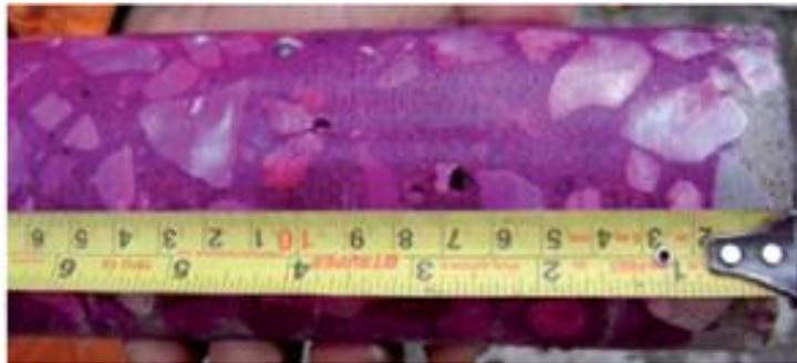
*Figura 14 Efecto de una muestra de concreto con aplicación de fenolftaleína, donde se aprecia las variaciones de color, la parte que toma el color fuchsia no está carbonatada, la zona que no cambia de color ha sido afectada por carbonatación*
