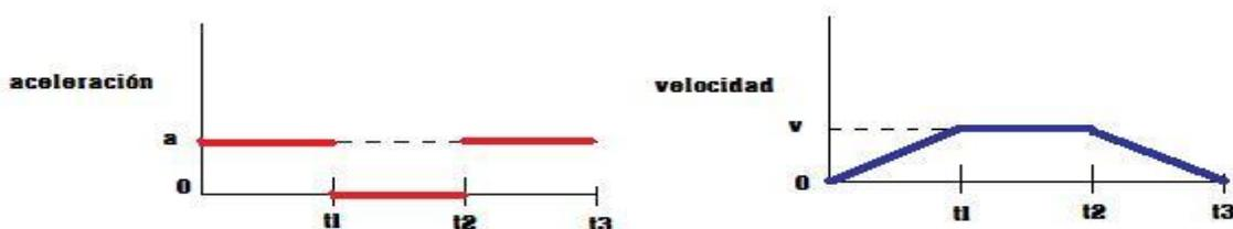
Figura 5-33: Perfil de trayectoria de primer grado
