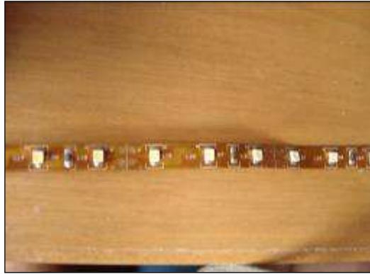
*Imagen 6-45 Tira de LEDs rojos utilizado para las direccionales.*
