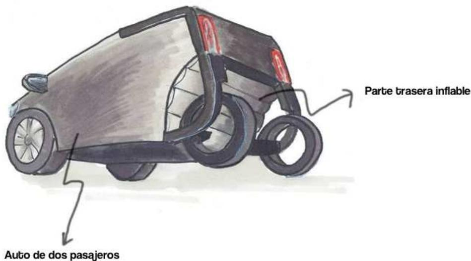
Imagen 5-6 Propuesta de diseño del Growing Car, configuración dos pasajeros
