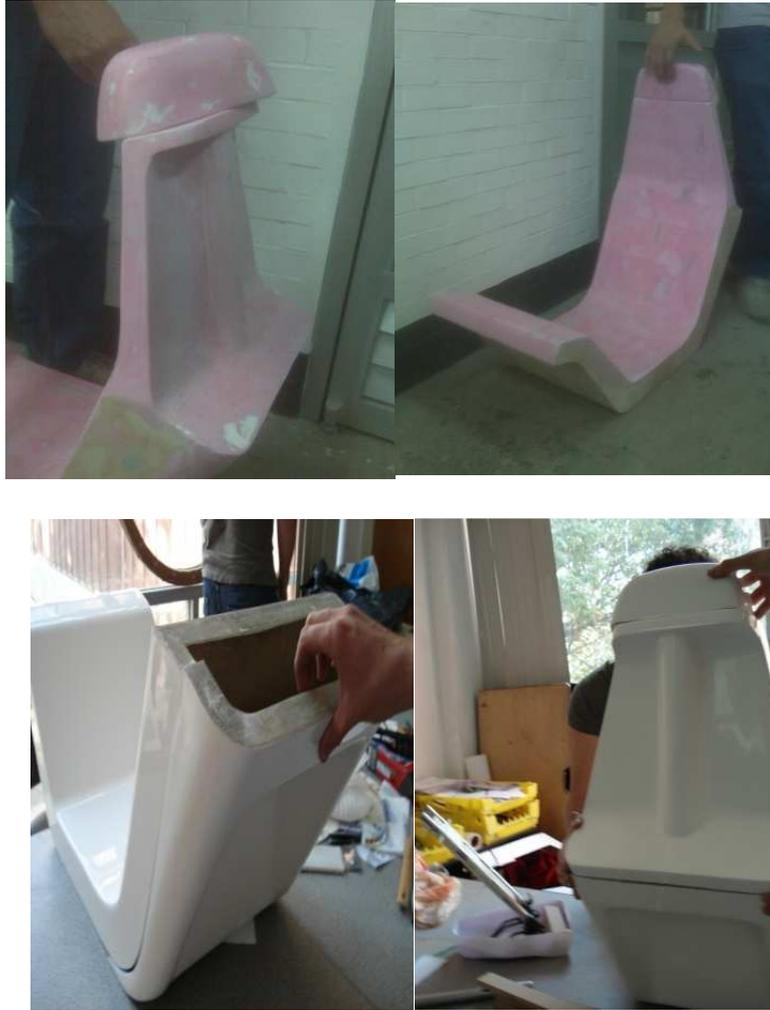
*Imagen 6-51 Molde y cubierta de fibra de vidrio.*
