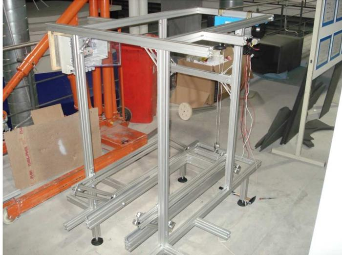
*Imagen 6-54 Estructura de aluminio y motor para levantar la moto.*
