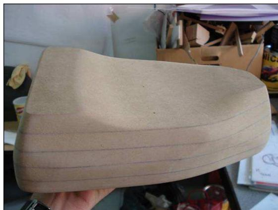
*Imagen 6-42 Molde de madera y prototipo final del asiento.*
