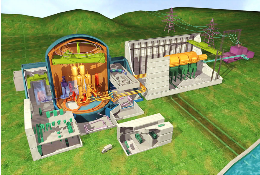
Figura 9. Reactor Europeo de Agua Presurizada (EPR) 17
