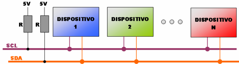
Figura 2.20. Conexión de dispositivos en el I^2C .
