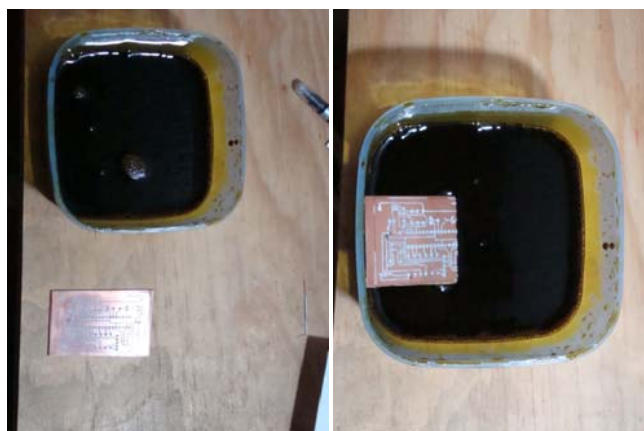
Figura 2.25. Revelado del circuito.
