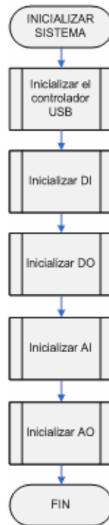
Figura 3.14. Diagrama de flujo de la subrutina Iniciar sistema.
