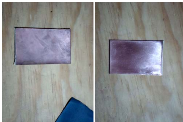
Figura 2.23. Tarjeta antes (izquierda) y después (derecha) de la limpieza.
