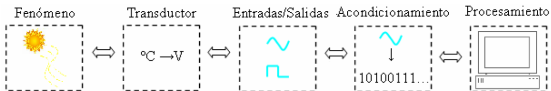
Figura 1.1. Esquema que ejemplifica la adquisición de datos
