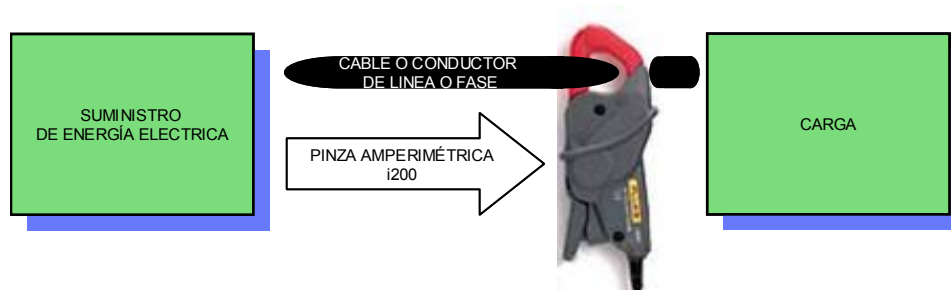
Figura 3.8 Posición de la pinza amperimétrica con conductores de fase o línea
