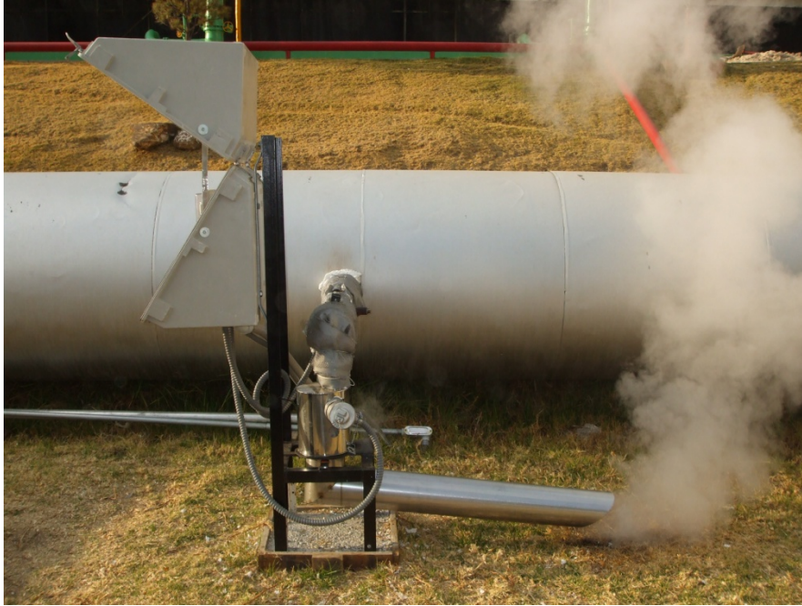
Figura 5.1 Medición de la entalpía
