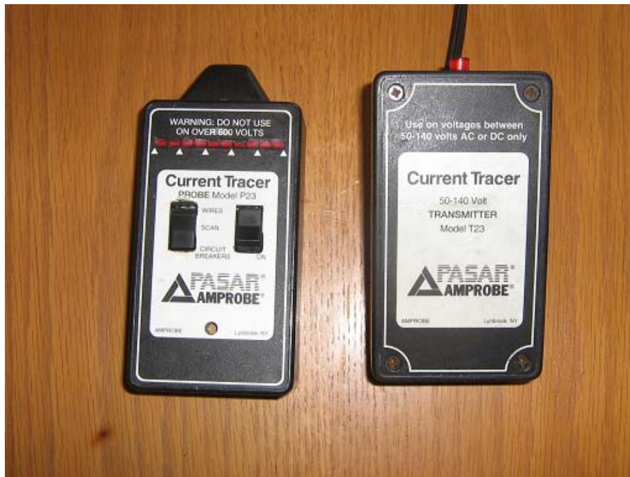
Figura 3.1. Trazador de corriente Amprobe P23.
