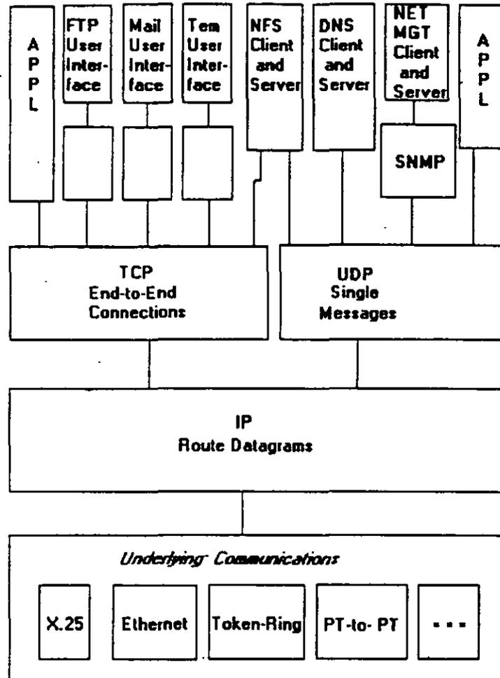
La figura (Fig 2.1) muestra la manera en que se complementan las partes del Conjunto de Protocolos TCP/IP. A pesar de que las interfaces al usuario para las aplicaciones *FTP*, *Telnet* y *DNS* han sido estandarizadas de manera formal, la mayoría de los proveedores ofrecen una colección de comandos que se encargan de copiar las interfaces al usuario de *UNIX Berkeley Software Distribution*.
