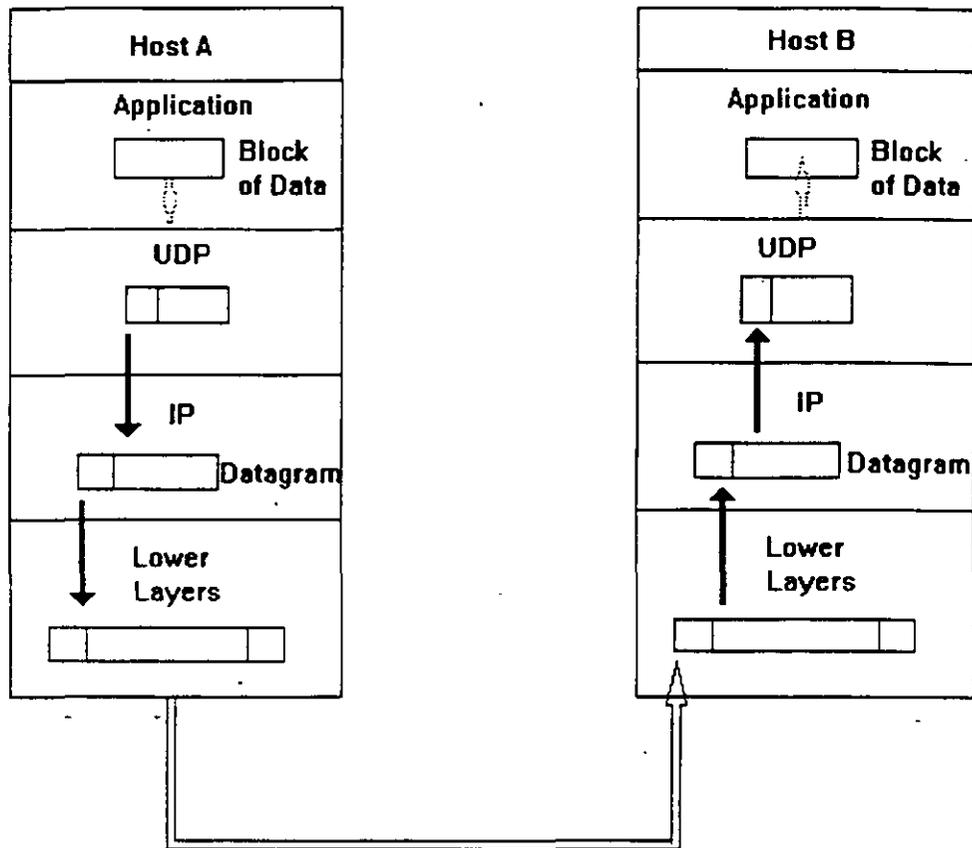
La figura (Fig 2.7) muestra como un bloque de datos se compacta y envía por UDP. Obviamente los mensajes de UDP deben ser enviados tanto por el emisor como por el receptor y el Host B puede estar concurrentemente en proceso de preparación de un bloque para enviar al Host A.
