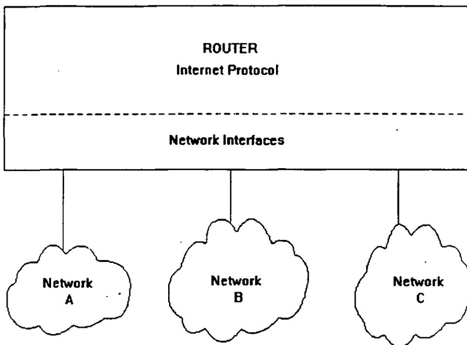
La figura (Fig 2.4), ilustra la arquitectura de protocolo de un *ruteador dedicado*. Debe observarse que no existe la necesidad de TCP debido a que las conexiones de las aplicaciones no inician ni terminan en el ruteador. Es evidente que un ruteador debe estar conectado al menos a dos redes.
