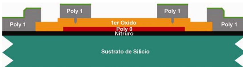
Figura B.8 La oblea es cubierta con fotorresist y el cuarto nivel (POLY1) es grabado.
