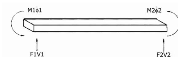
Figura 1.25. Diagrama pictórico de una barra en modo flexión
