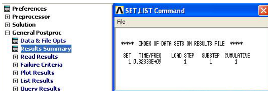
Figura 4.32. Frecuencia de resonancia resultado de la simulación.
