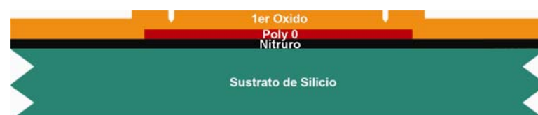
Figura B.5 Hoyuelos de 750nm son extraídos de la primer capa de sacrificio.
