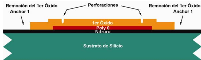
Figura B.6 El tercer nivel (ANCHOR1) es litográficamente dibujado.
