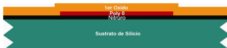
Figura B.4 Depósito de la primer capa de sacrificio.
