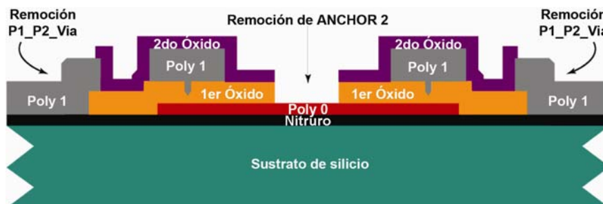
Figura B.11 La oblea es recubierta con fotorresist y ANCHOR2 es dibujado con litografía. Los dos óxidos son removidos mediante RIE y ANCHOR2 provee de contacto a Poly2 con el Nitrúro o con Poly0.
