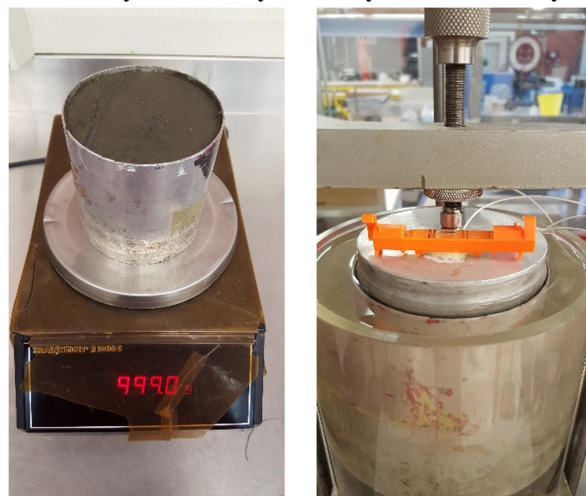
Fotografía 5.6. Muestra y tubo shelby del ensayo P-3 antes del montaje y durante su ejecución.
