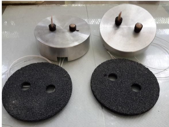
Fotografía 4.2. Cabezal y pedestal instrumentados y sus respectivas piedras porosas
