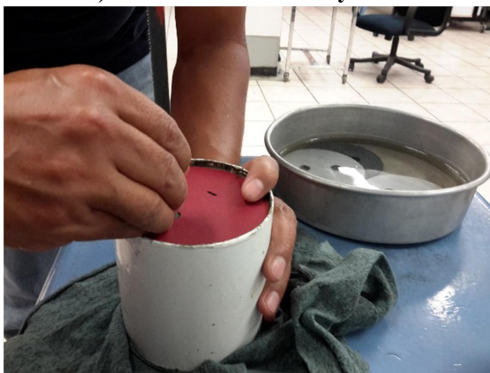
c) Ranurado para colocación de BE
