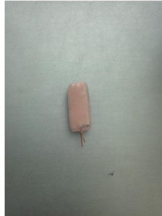
d) Elemento de flexión encapsulado
