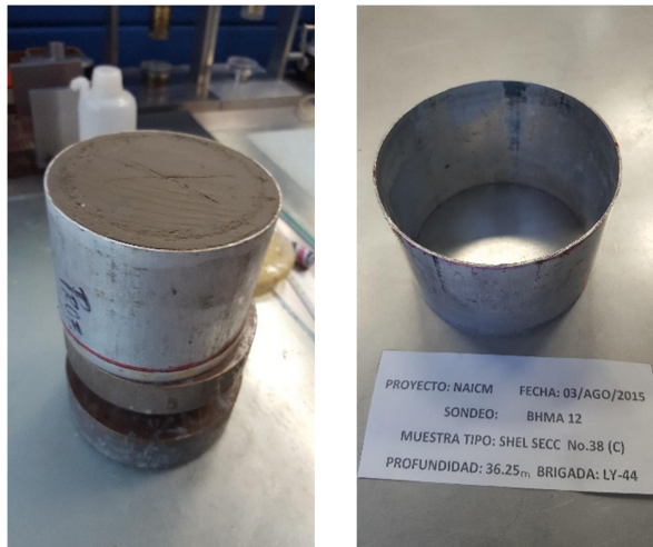
Fotografía 5.5. Muestra y tubo shelby del ensayo P-2/P-8 antes y después del montaje
