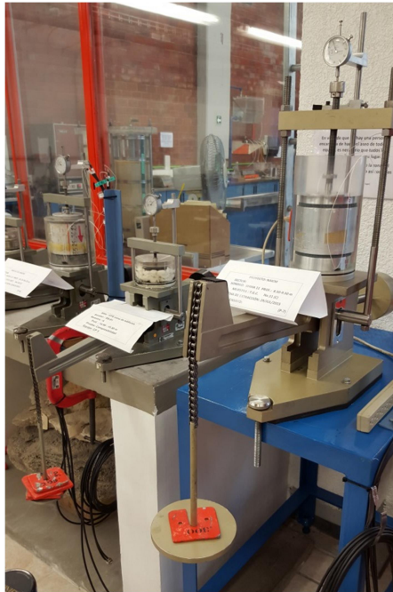
Fotografía 4.1. Equipo de consolidación diseñado para permitir una deformación axial de 25 mm.
