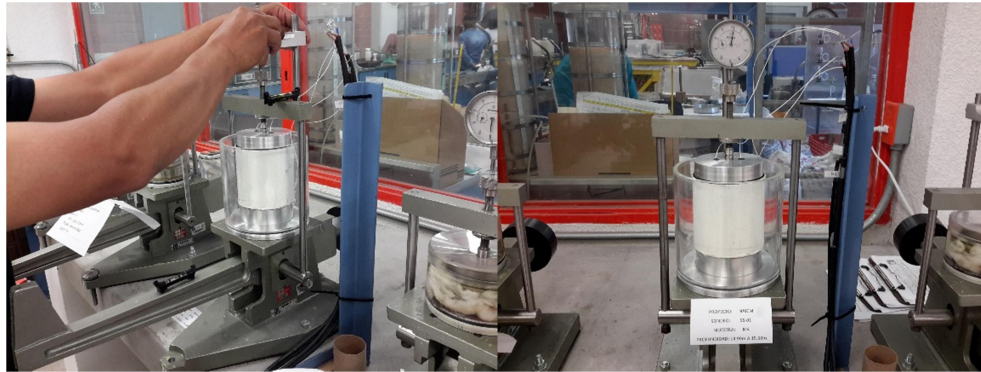
e) Colocación de cazuela
