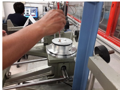
d) Colocación de piedras porosas y papel filtro
