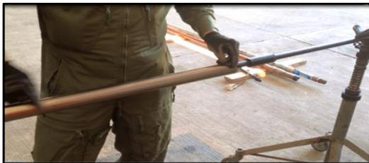
**Figura 5.12** Desmontaje de la BSSMA, no se observa daño <sup>[17]</sup>.
