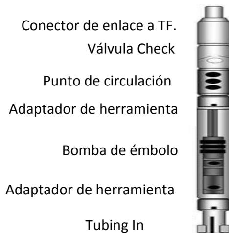
**Figura 4.1** Diagrama del Ensamble de Fondo<sup>[3]</sup>
