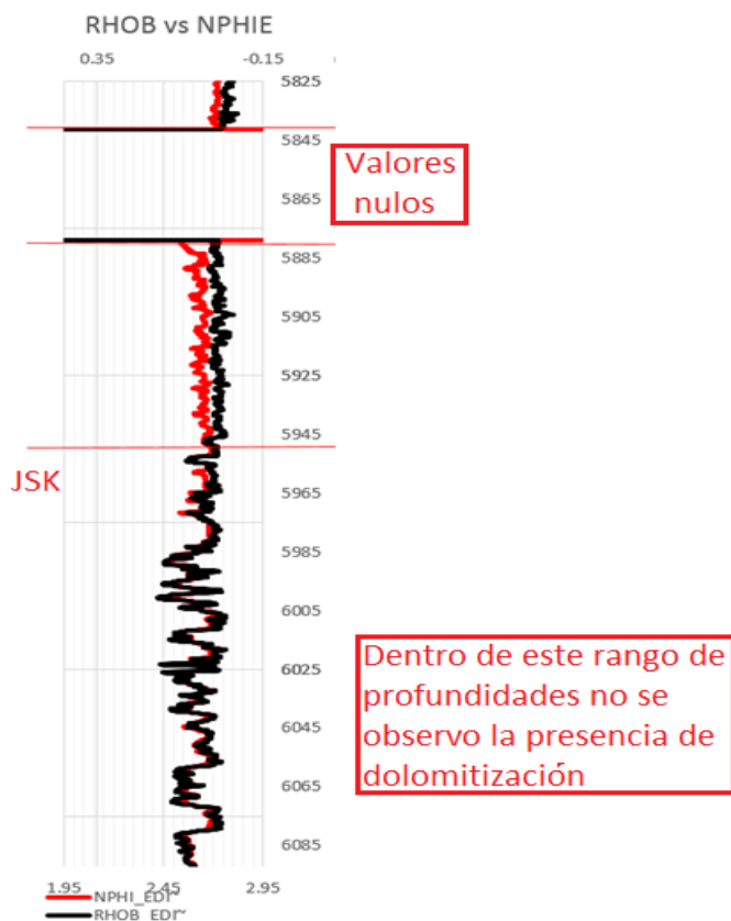
Figura 95.- Integración de datos: registro geofísico curvas (RHOB vs NPHIE); ya que dentro del rango del registro graficado no se encontró dolomitización nos apoyamos en muestras de canal (desafortunadamente no se tienen fotos del informe petrográfico).
