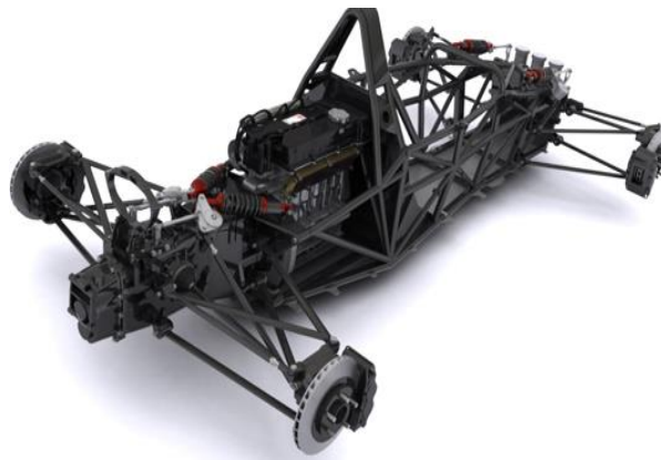
Imagen [9]: Estructura de un chasis tipo cercha ( http://simulatori.virtualracinggroup.net/files/2012/03/002.jpg )
