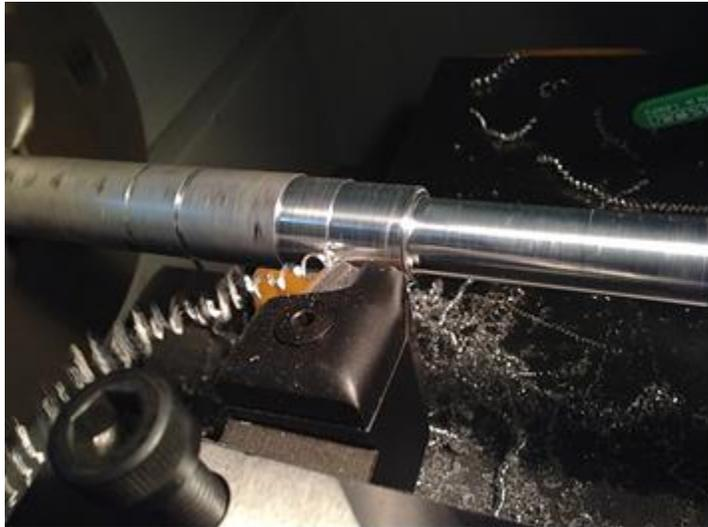
**Figura 3.13.-Prueba experimental de maquinado en aluminio 6061 T6.**
