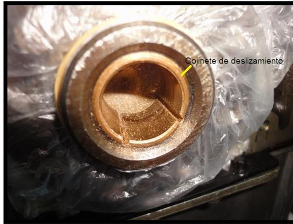
**Figura 6.15.- Cojinete de deslizamiento.**
