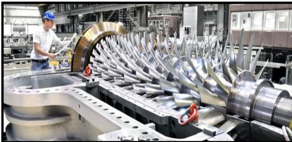
**Figura 6.7.- Foto de los álabes de una Turbina**
