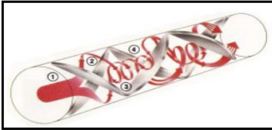
**Figura 8.6.- Principio de operación de un mezclador estático**
