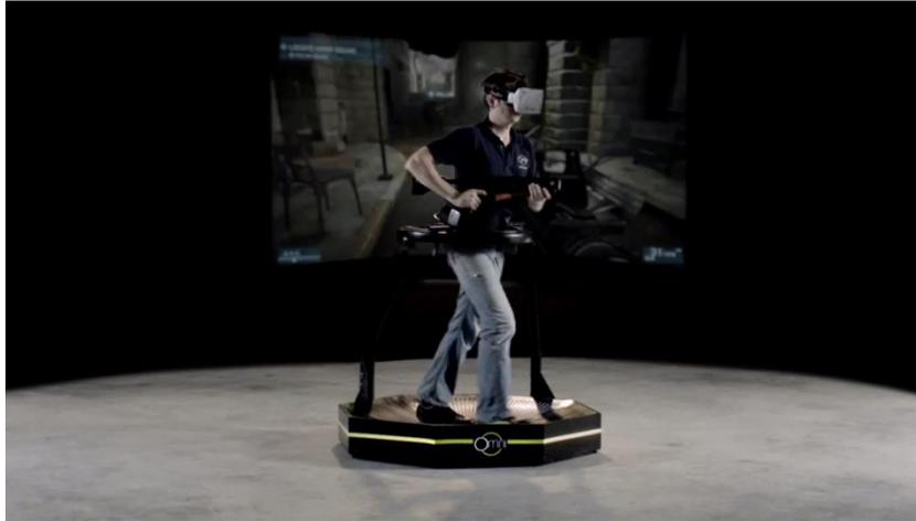
Figura 1-2. Plataforma de movimiento de Realidad Virtual llamada Virtuix Omni (Virtuix, 2016).
