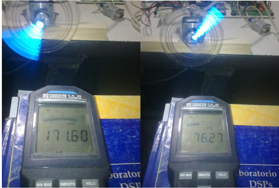
Figura 8.7 Medición de las velocidades configuradas en el código del C50.
