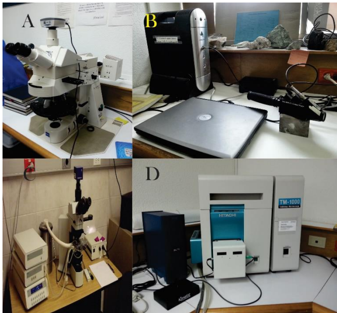
Figura 3.1. Equipo utilizado para este trabajo. A- Microscopio petrográfico, B- Espectrómetro, C- Microscopio con platina térmica, D- Microscópio electrónico de barrido.
