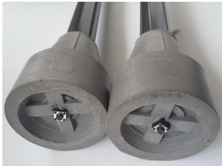
**Ilustración 33. Montaje de los sensores en la contera.**
