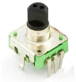
**Ilustración 26. Rotary Encoder [62.]**
