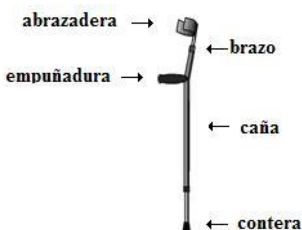
Ilustración 3. Elementos de una muleta de antebrazo [7.]
