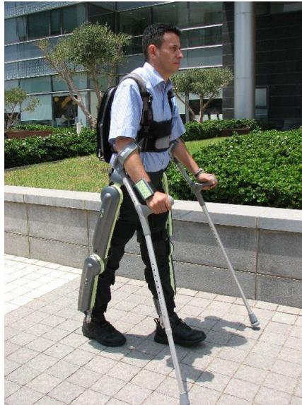
Ilustración 6. Exoesqueleto ReWalk® [6.]
