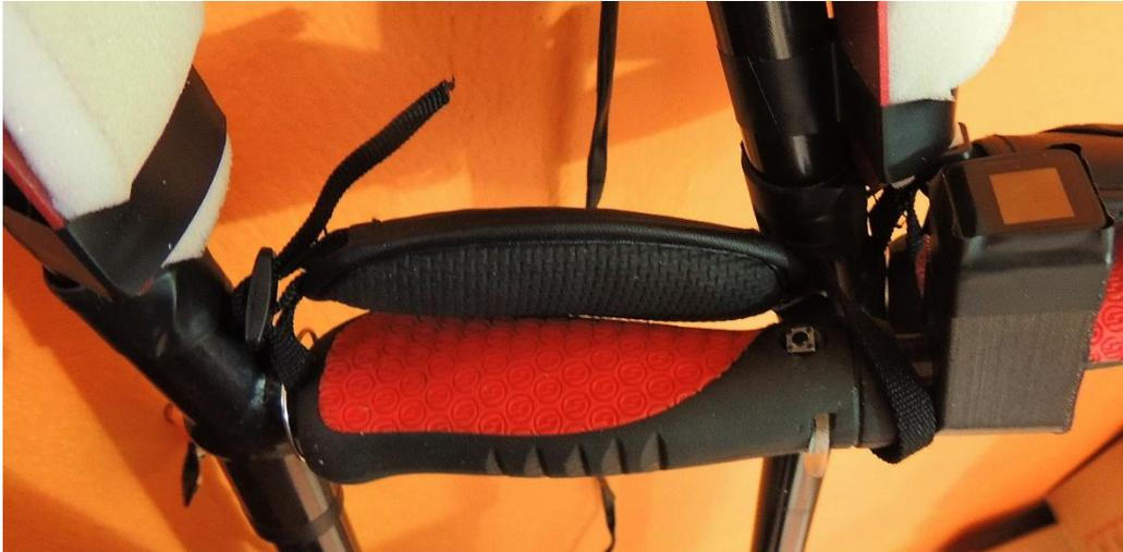
**Ilustración 32. Empuñadura derecha con scroll y botón de selección.**
