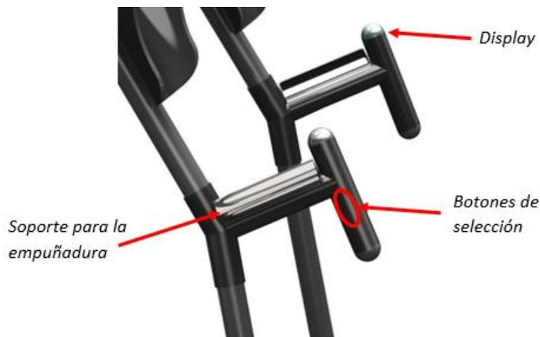
Ilustración 16. Concepto 5: Diseño de la empuñadura dibujada en NX 10.
