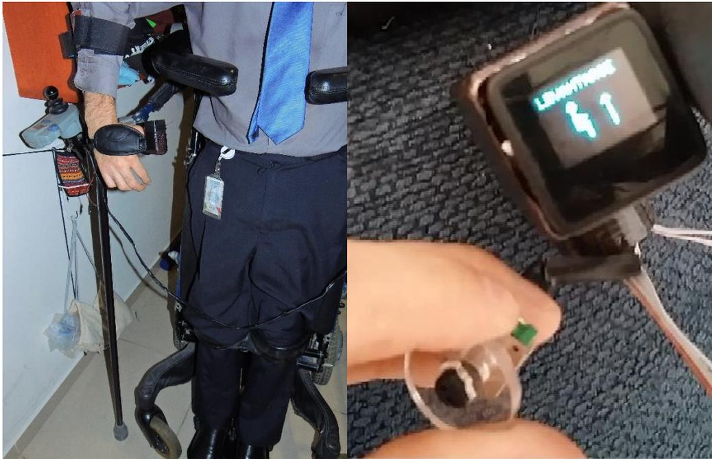
**Ilustración 37. Control de las secuencias programadas antes y después de ser montadas en la muleta.**
