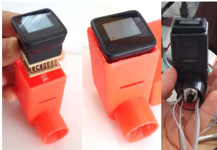
Ilustración 31. Montaje de las placas en la carcasa del MicroView.
