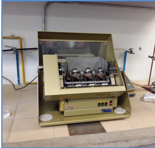
Figura 131. Sistema automático de fusión operado con microprocesador y tres quemadores (Mod. Fusión, fluxy claisse). Tomada en el Laboratorio de Fluorescencia de Rayos X, Instituto de Geología.
