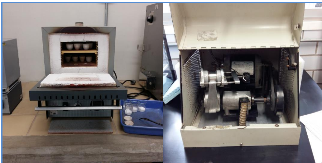
Figura 130. En la imagen de la parte izquierda se muestra la estufa que se utilizó para el secado de las muestras. En la imagen de la parte derecha se muestra el molino de bolas de tungsteno. Tomadas en el Laboratorio de Fluorescencia de Rayos X, Instituto de Geología.
