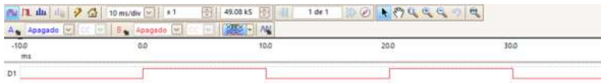
Figura 4.7 Señal con frecuencia de 50[Hz] utilizada para probar velocidad de captura del núcleo de comunicación Ethernet
