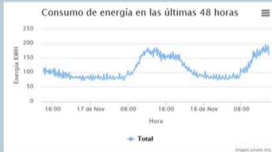
Figura 4.22 Página Web del cliente/servidor que muestra la información generada, a partir de la recolectada en el archivo de transferencia del Medidor de Consumo EA del edificio 5 del Instituto de Ingeniería de la UNAM
