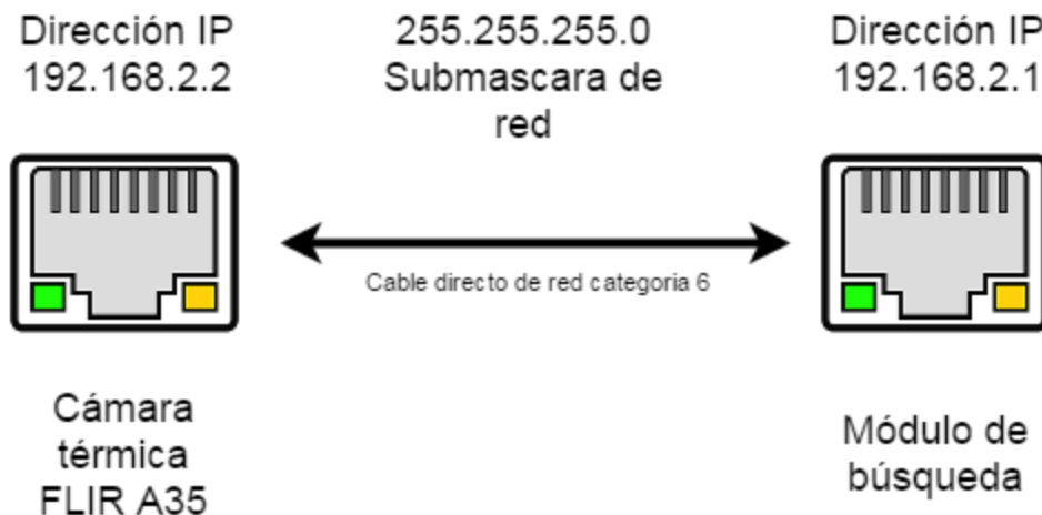
Figura D.4 Diagrama de configuración de red de los puertos Giga Ethernet para conectar la cámara FLIR A35 al módulo de búsqueda.
