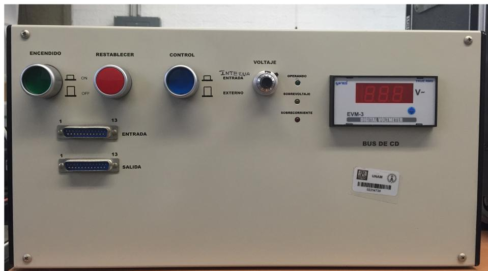
FIGURA A.5: Rectificador-inversor trifásico de 3kW
