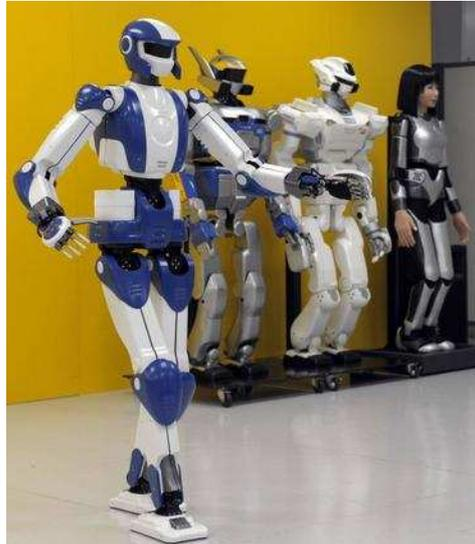
*Figura 2.6: Hasta el frente, HRP-4 y sus versiones anteriores.*
