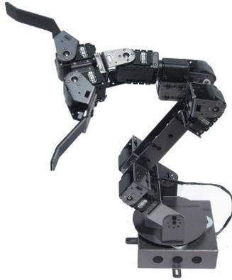
Figura 2.4: Brazo robótico estacionario.
