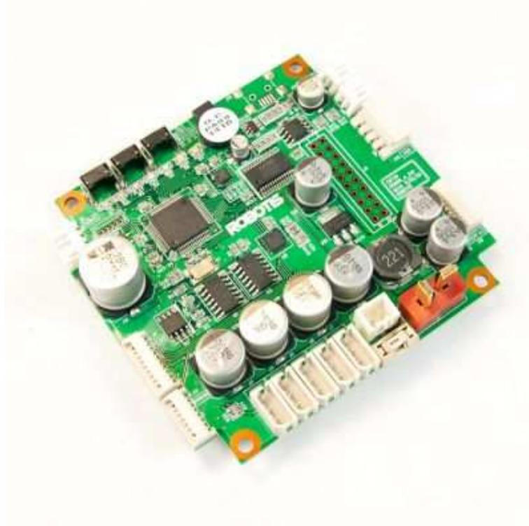
*Figura 3.3: Tarjeta sub-controladora CM730*
