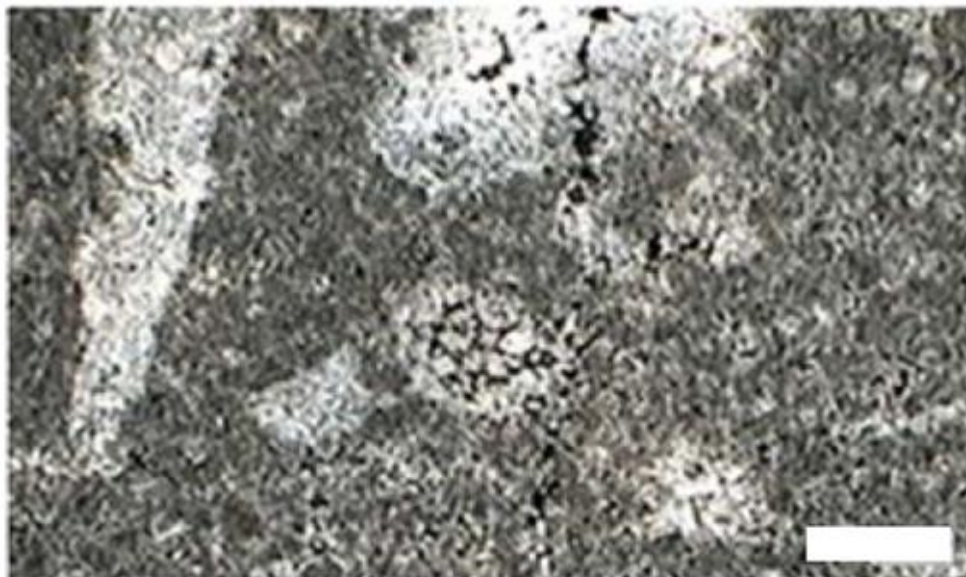
Figura 3.9 Roca almacén del Albiano-Cenomaniano del Área Chiapas-Tabasco con textura original de Packstone (AMGP Delegación Villahermosa, 2008).
