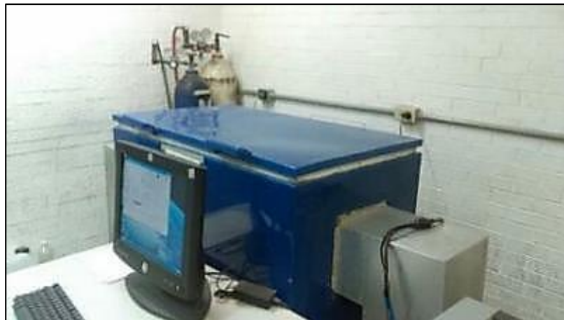
Figura. 3.1. Cámara para ensayos acelerados de corrosión atmosférica.
