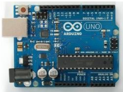
Figura 4.6 Tarjeta Arduino UNO R3
