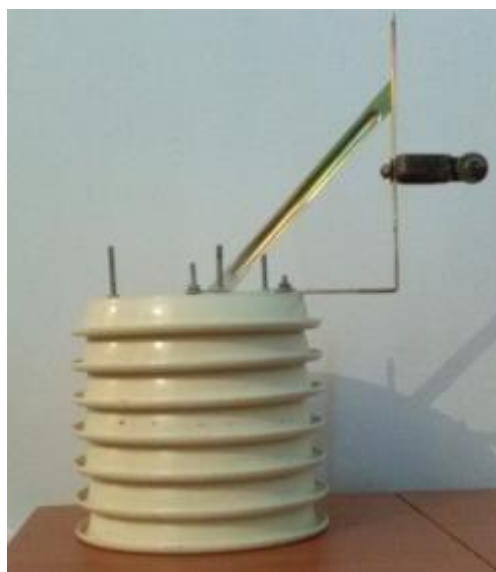
Figura 3.5. Presentación del modelo final de la garita meteorológica.
