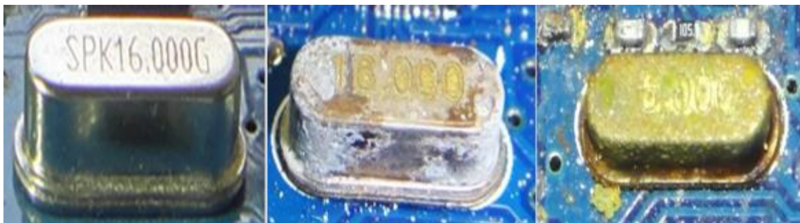
Figura 4.17. Cristal Oscilador de 16 MHz.
