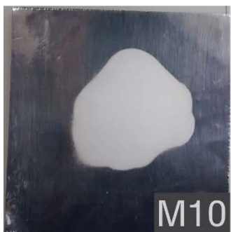
Figura 36 Membranas electrohiladas con un colector "convencional". (Obtenidas mediante fotografías digitales).
