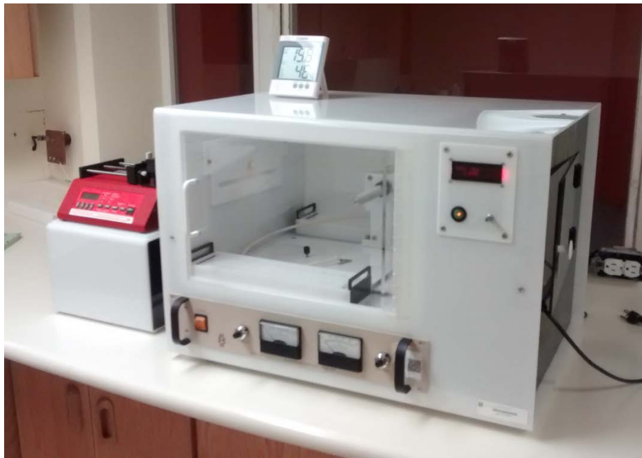
Figura 13 Ejemplo de un aparato de electrohilado.
