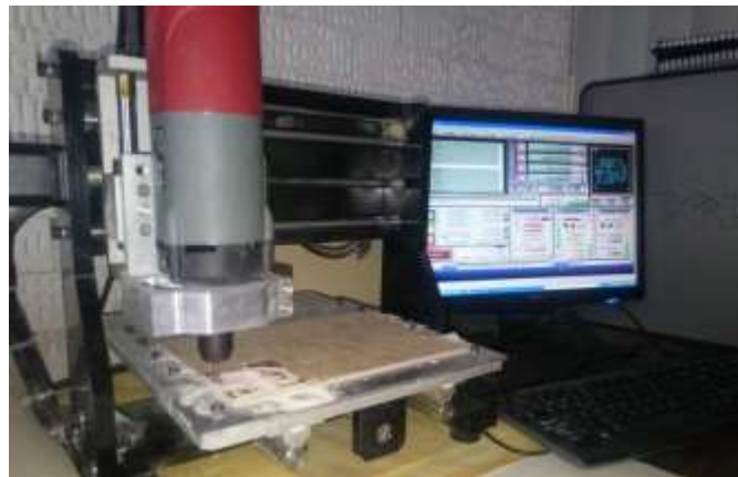
Perforación y grabado en placa.
