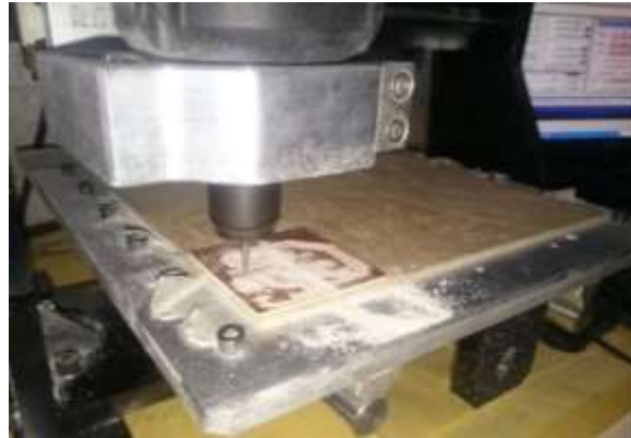
Perforación y grabado en placa.
