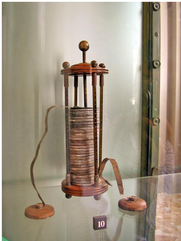
**Figura 1.1:** Pila de Volta. Imagen: GuidoB [GFDL, CC-BY-SA-3.0, Wikimedia Commons]
