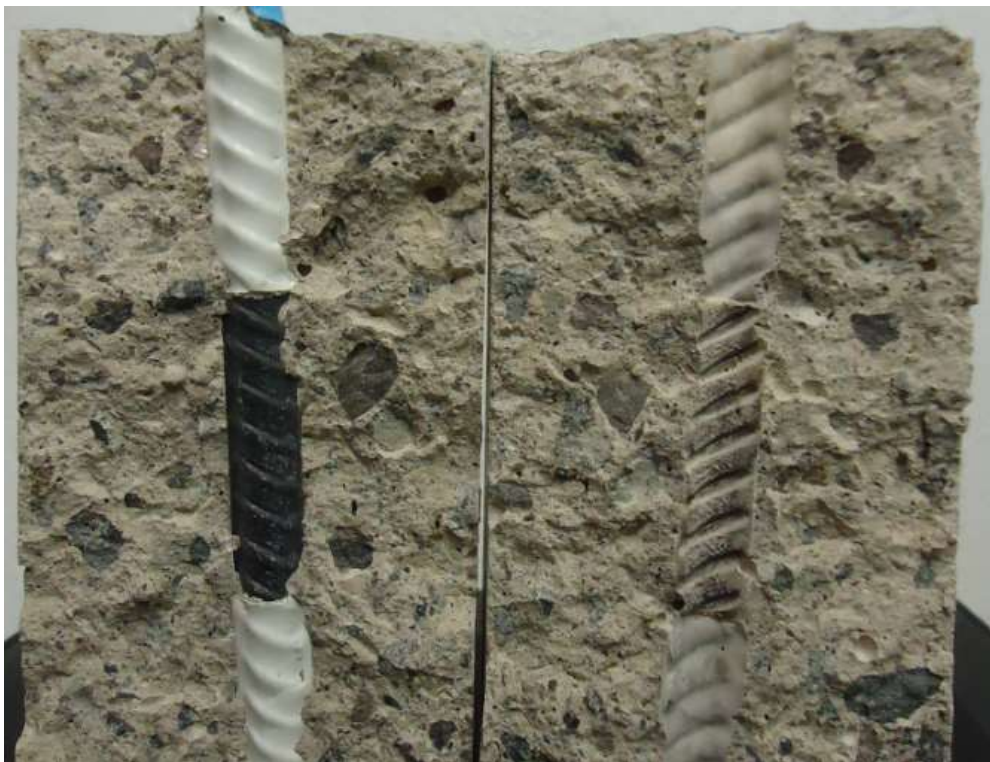
Figura 3. 40.- Detalle concreto con agregado reciclado tratado carbonatado.
