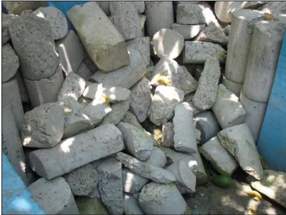
Figura 3.2.- Clasificación y almacenamiento de residuos de concreto.
