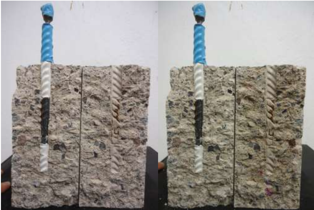
Figura 3.37.- Concreto con agregado reciclado carbonatado.
