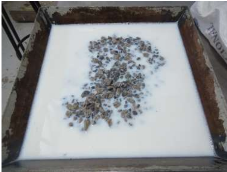
Figura 3.9.- Tratamiento del agregado reciclado.
