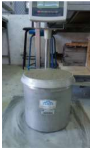
Figura 3.14.- Peso volumétrico del concreto.
