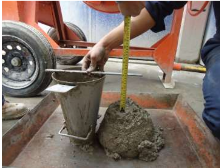
Figura 3.13.- Revenimiento del concreto.
