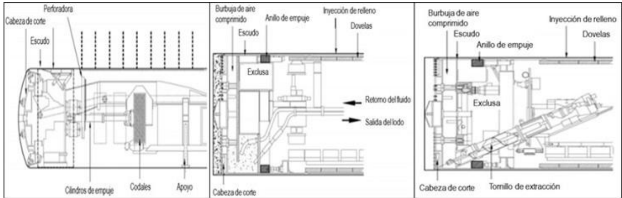
Figura 3.6 Tipos de tuneladoras existentes.
