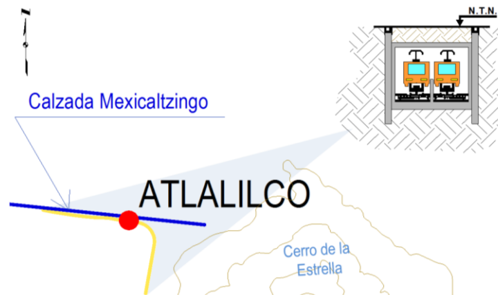
Figura 3.11 Sección en cajón somero.
