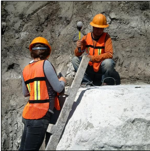
Figura 2.1 Adquisición de prueba de integridad de pilas (Izq.) Instalación de Sensor para vibración ambiental (Der.)
