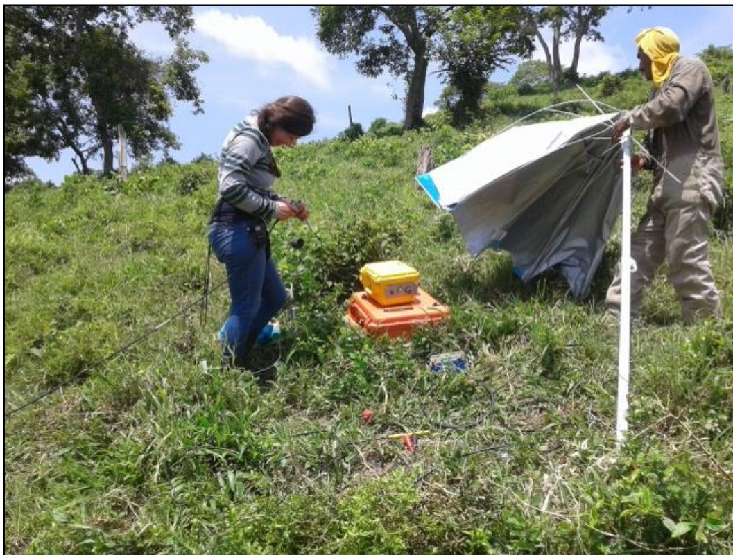
Conexión del equipo Geode a la sonda sísmica, para la adquisición de TRS # PS024
