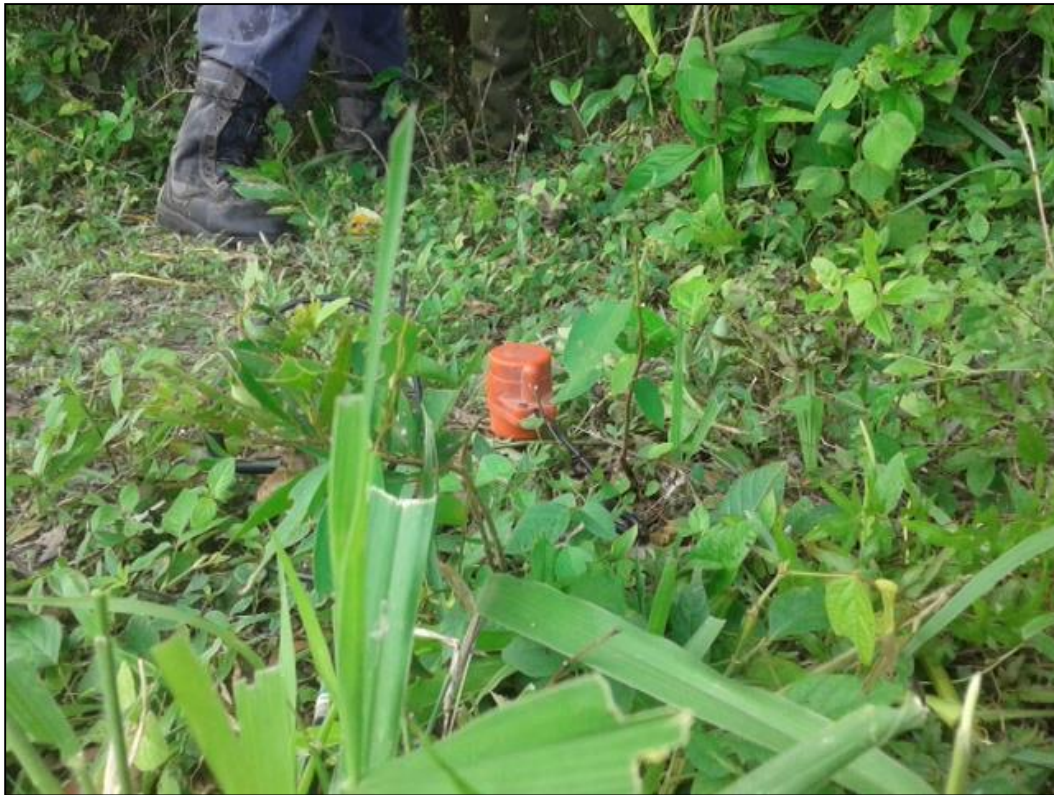
Sensor de 4.5 Hz, empleado para la adquisición de datos sísmicos.
