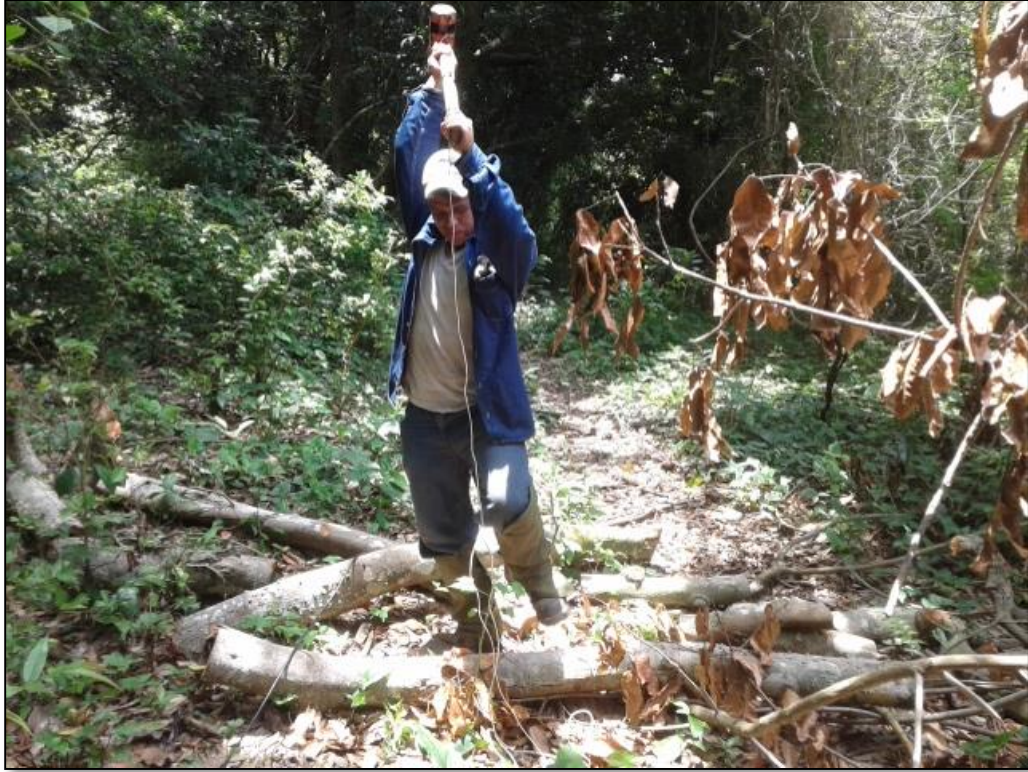
Generando fuente sísmica para la adquisición del TRS.
