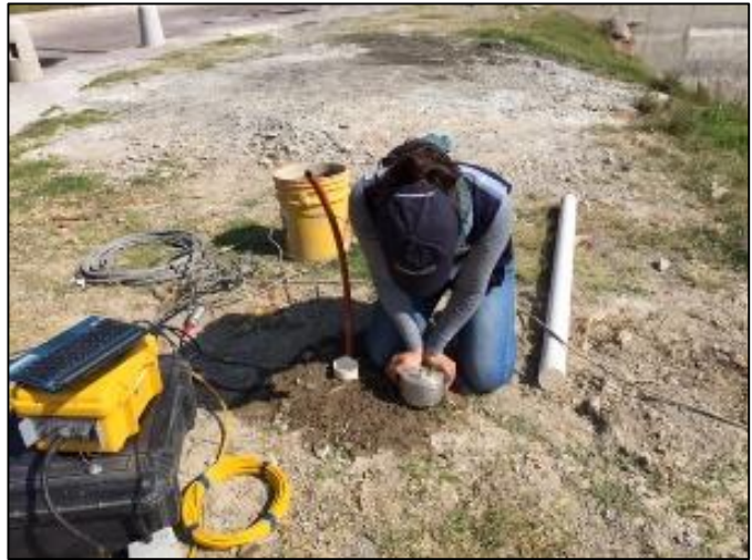
Figura 2.1 Adquisición de prueba de integridad de pilas (Izq.) Instalación de Sensor para vibración ambiental (Der.)
