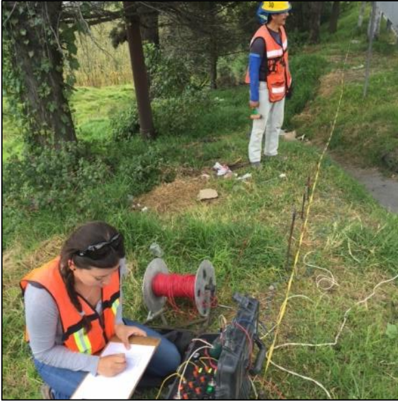
Figura 2.2 Adquisición de SEV (Izq.) Adquisición de Tomografía eléctrica en arreglo polo-dipolo (Der.)
