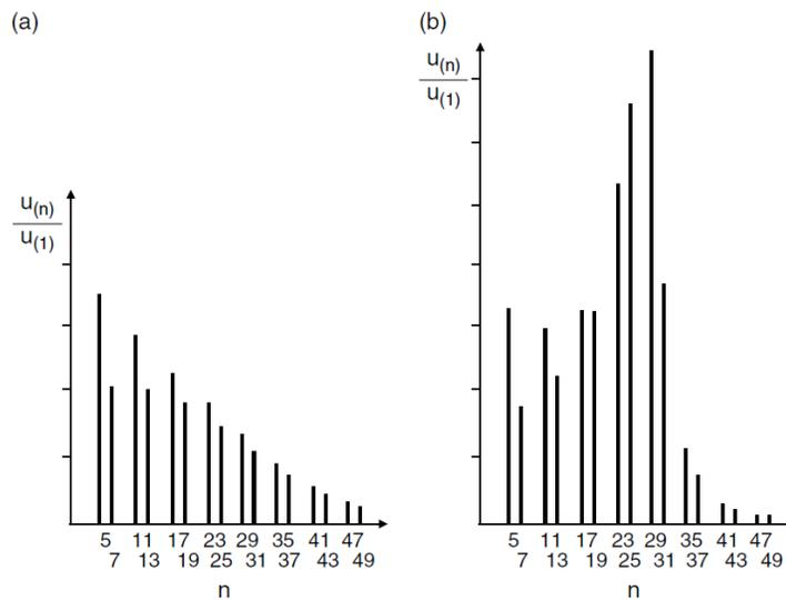
FIGURA 4.2 EJEMPLO DE ESPECTRO ARMÓNICO (Baggini, 1998)
