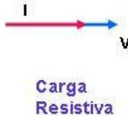
FIGURA 2.4 REPRESENTACIÓN VECTORIAL DE LAS MAGNITUDES DE CORRIENTE Y TENSIÓN EN FASE<sup>4</sup>.
