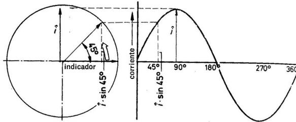
FIGURA 2.1 FORMA IDEAL DE UNA ONDA SENOIDAL DE CORRIENTE<sup>1</sup>.
