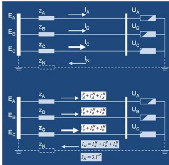
FIGURA 3.5 SISTEMA TRIFÁSICO SIMÉTRICO CON CARGA DESBALANCEADA
