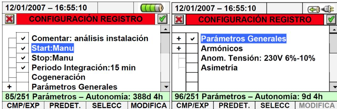
FIGURA 6.12 PANTALLA CONFIGURACIÓN REGISTRO (HT ITALIA).
