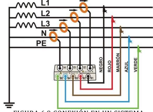
FIGURA 6.9 CONEXIÓN EN UN SISTEMA TRIFÁSICO A 4 HILOS.
