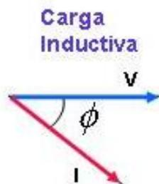
FIGURA 2.6 REPRESENTACIÓN VECTORIAL DE LAS MAGNITUDES DE CORRIENTE Y TENSIÓN DE UNA CARGA INDUCTIVA<sup>5</sup>
