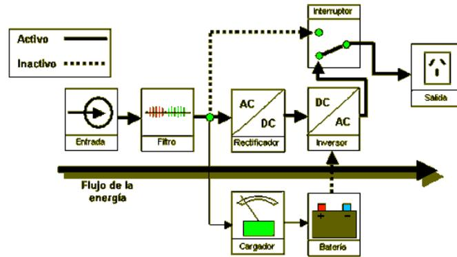
Fig.4 **UPS On-Line** / Funcionamiento en modo línea normal
