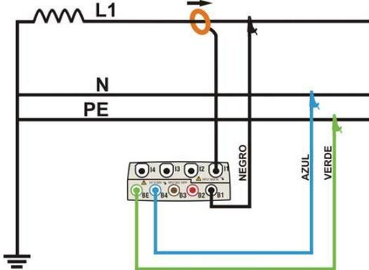
FIGURA 6.8 CONEXIÓN DEL ANALIZADOR EN UN SISTEMA MONOFÁSICO.
