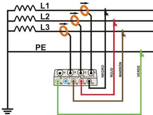
FIGURA 6.10 CONEXIÓN EN UN SISTEMA TRIFÁSICO A 3 HILOS
