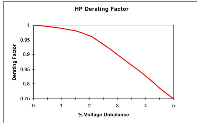
FIGURA 3.6 FACTOR DE REDUCCIÓN DE POTENCIA (NEMA).
