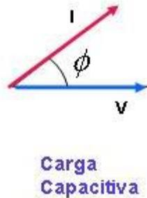
FIGURA 2.5 REPRESENTACIÓN VECTORIAL DE LAS MAGNITUDES DE CORRIENTE Y TENSIÓN DE UNA CARGA CAPACITIVA
