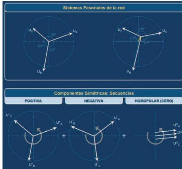
FIGURA 3.3 REPRESENTACIÓN FASORIAL DE UN SISTEMA TRIFÁSICO<sup>8</sup>
