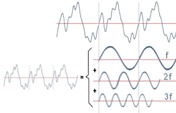
FIGURA 2.2. ONDA FUNDAMENTAL Y SUS ARMÓNICAS<sup>2</sup>.
