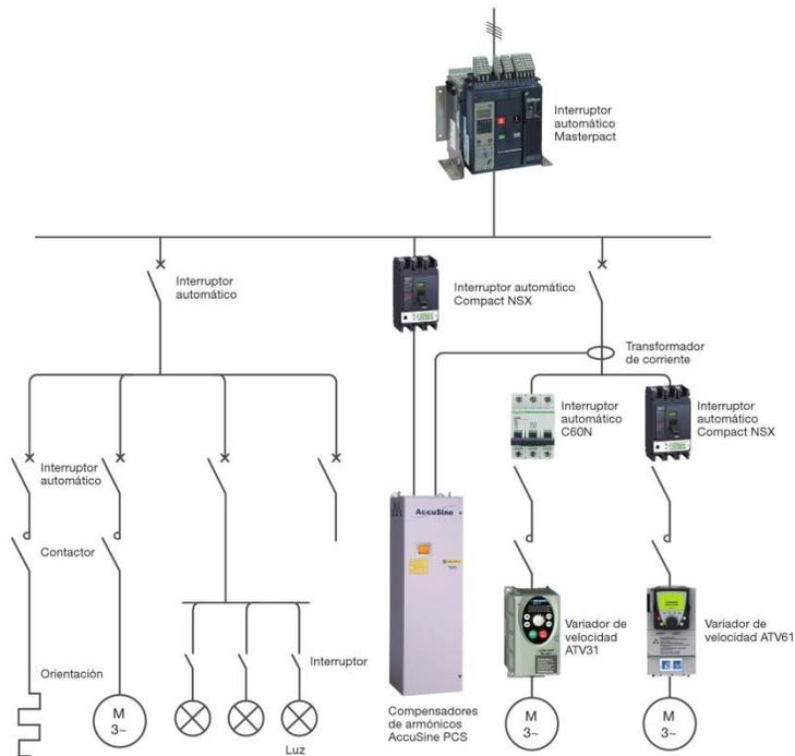
FIGURA 5.2 DIAGRAMA DE UN FILTRO DE ARMÓNICO INTEGRADO EN UNA INSTALACIÓN ELÉCTRICA<sup>11</sup>.
