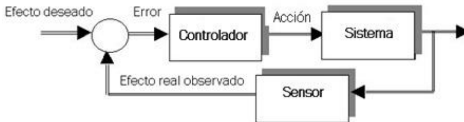
Figura 4-4. Sistema de control por retroalimentación (Tomada de [34]).
