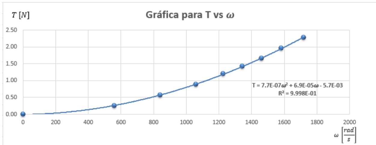
Figura A.4-5. Gráfica de empuje contra velocidad angular para el par motor-propela.
