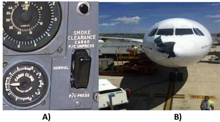
**Figuras 10 y 11.- (A) Despresurización lenta por el fallo del sistema de presurización, (B) Despresurización rápida o explosiva por agrietamiento en el fuselaje.**
