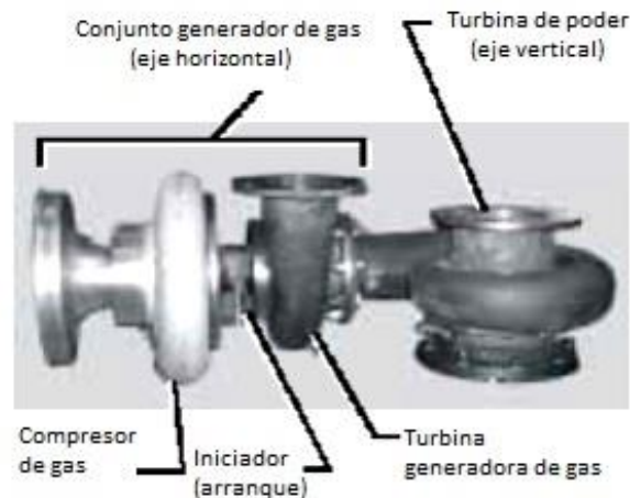
Figura 17) Componentes del motor (modificado de Ingersoll-Rand Energy Systems, 2002).
