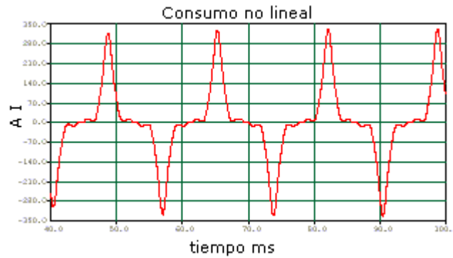
Figura 1.6 Forma de onda con distorsión armónica.
