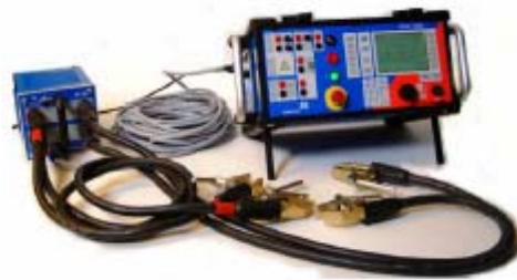
Maleta multifuncional para pruebas a equipos de subestaciones eléctricas.
