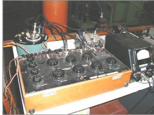
Figura 5.18. Muestra de aceite vertida en la celda y equipo para prueba de factor de potencia.
